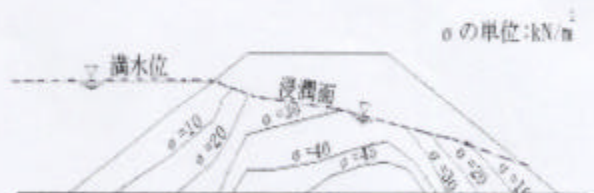
図-4 堤体浸潤面下の応力(σ)分布図 5)
