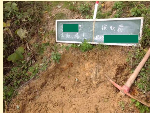
①土取場候補地で土を採取(これを土質試験=物理・力学試験)
